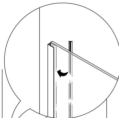
engomar cristal fijo y "U" y colocar la pinza baja en el extremo del vidrio
