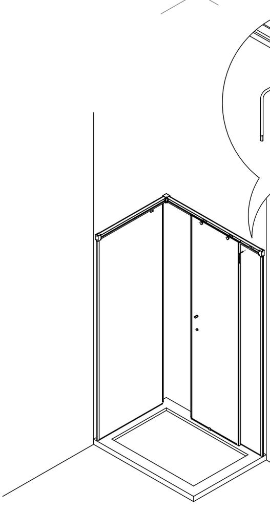
cortar el perfil bajo a medida, desde la pinza baja hasta el otro cristal fijo, colocandole el embellecedor y situar por delante de la hoja corredera
