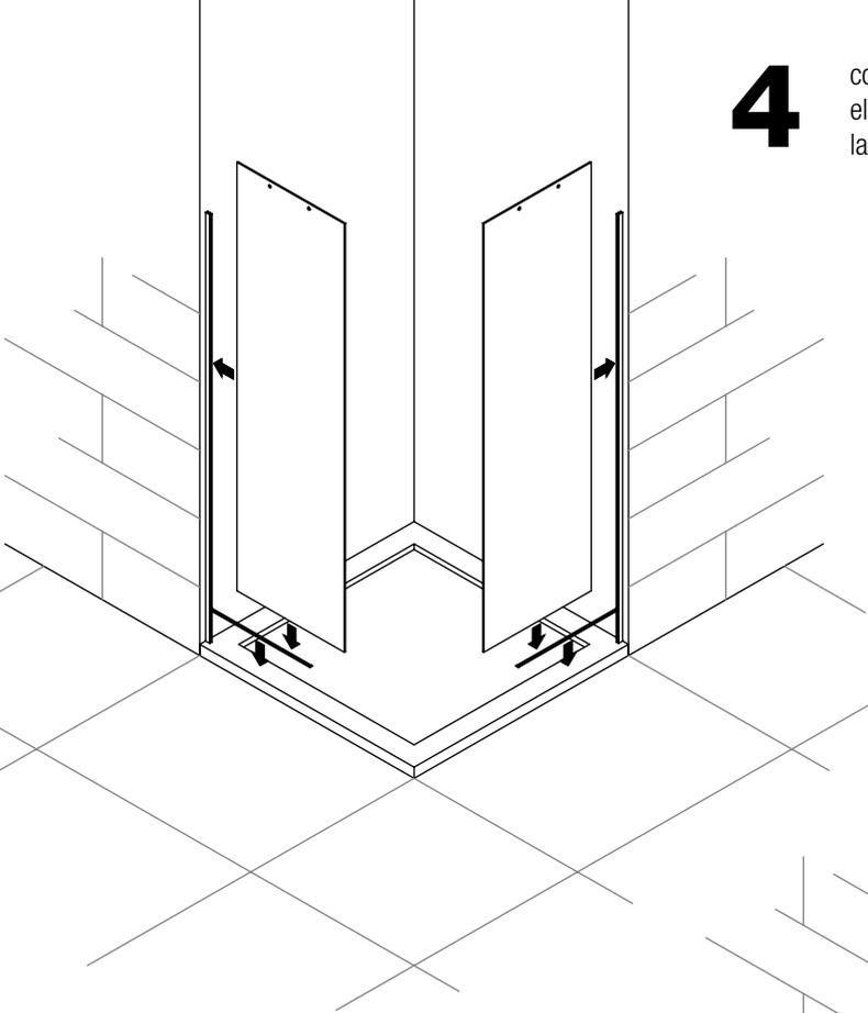
engomar cristal fijo y "U" y colocar la pinza baja en el extremo del vidrio
